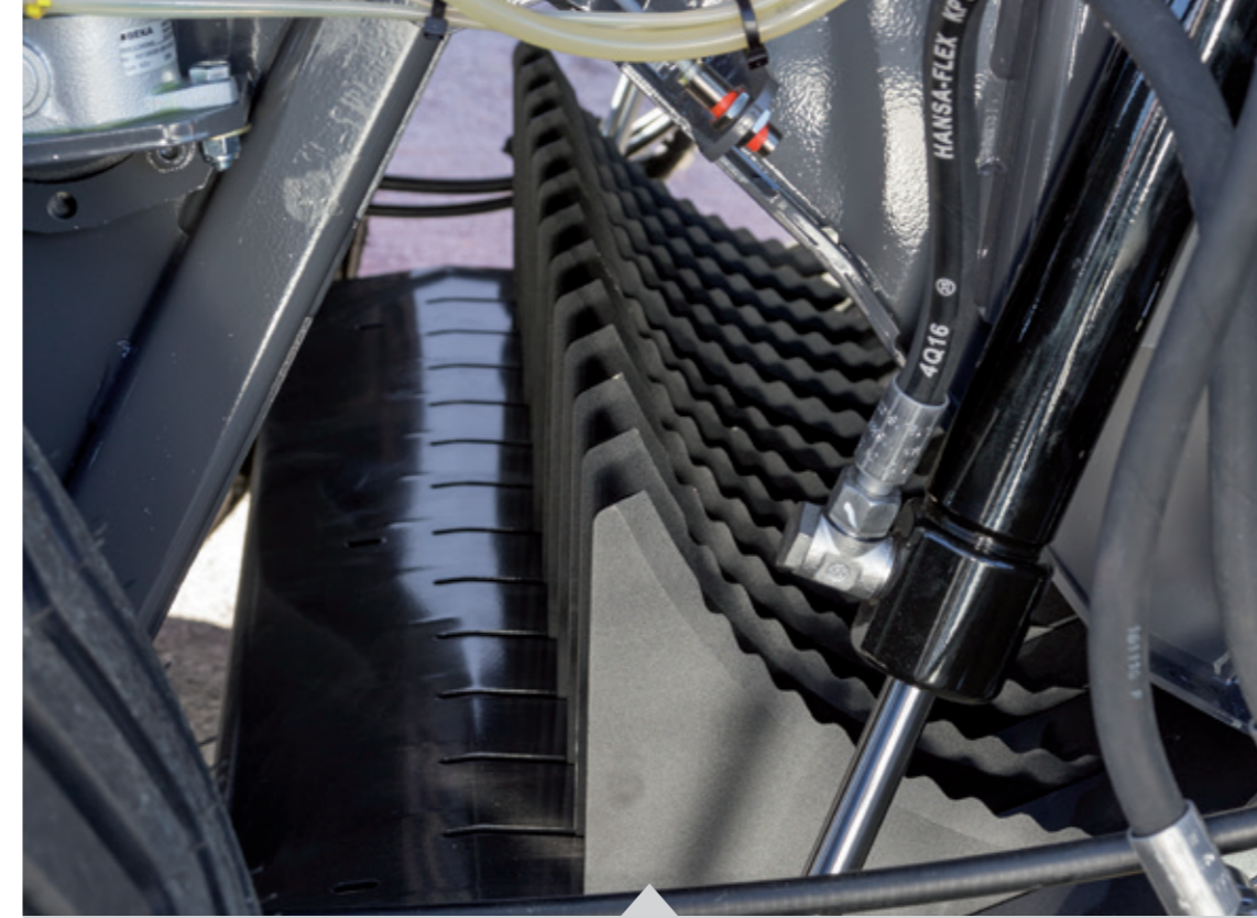
Xtracut 13 rotor, 90 mm ürün kesme uzunluğu sunar
